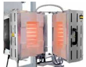
RS 100/250/11S w wersji składanej do zamontowania w urządzeniu badawczym
